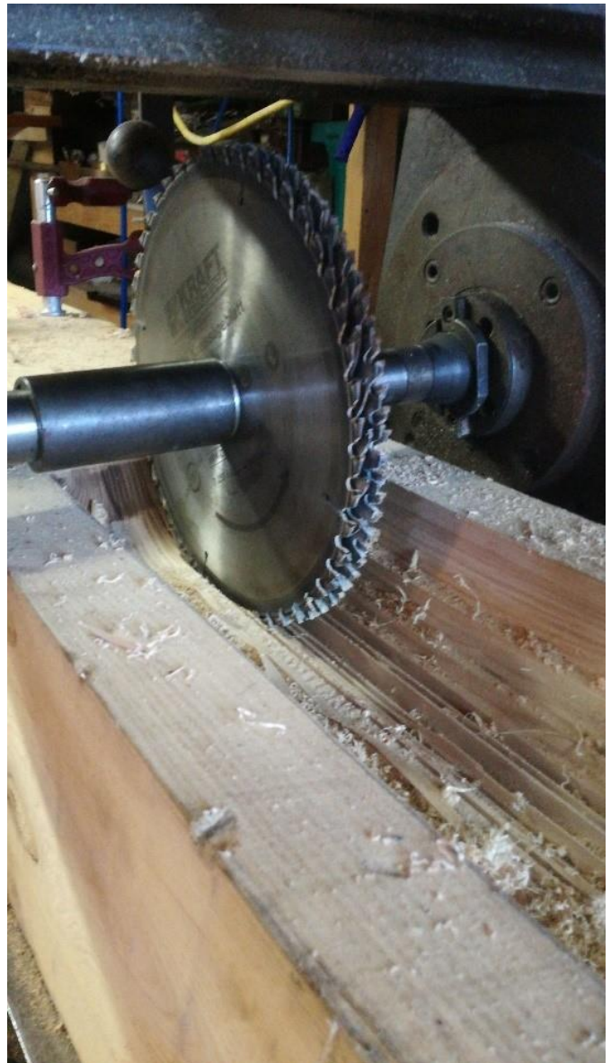
Ausfräsen der Rohrwiege aus der Oberlade Querschnitt 20x20cm Länge 2 m
