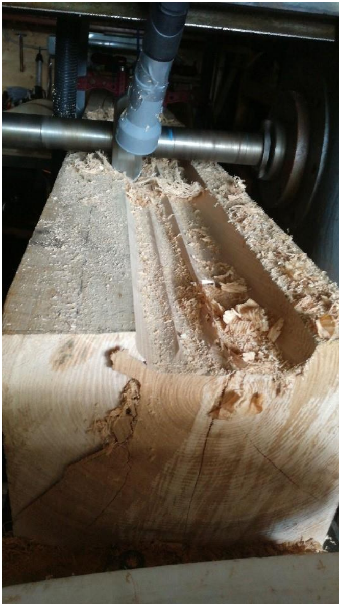
Ausfräsen der Rohrwiege aus der Oberlade Querschnitt 20x20cm Länge 2 m
