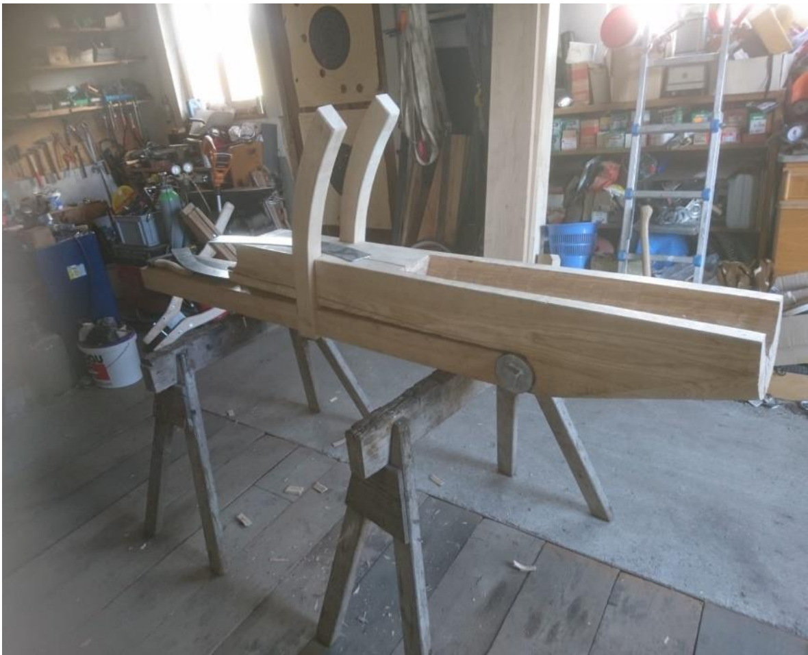
Hier die vormontierte Lade. Unterlade, Oberlade und Richthörner. Bereit um das Rohr aufzunehmen und die Achse einzusetzen. Dabei ist auf eine gleichmäßige Gewichtsverteilung zu achten, so dass die Kanone hinten nicht zu leicht oder zu schwer wird. Also ausgewogen, damit sie leicht aufgenommen werden kann, aber doch genug Masse hat, um sicher zu stehen.
