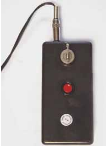
Abb. 20: Batteriebetriebene Zündvorrichtung für Kanone mit elektrischer Zündung
