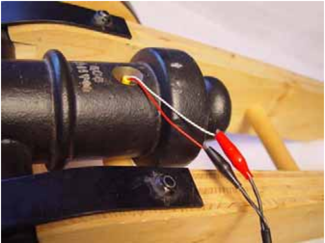
Abb. 19: Vorderladerkanone mit elektrischer Zündung
